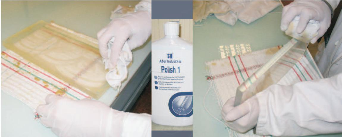
FIG. 3 – Polissage d'un scintillateur
