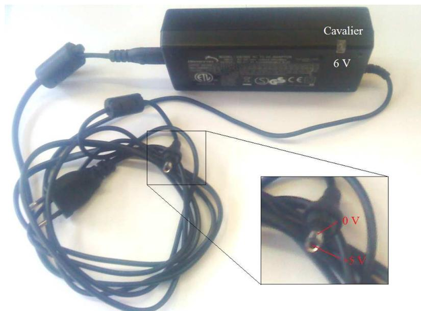
FIG. 8 – Alimentation universelle stabilisé et régulée 6 V.
